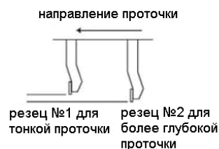
Проточка с помощью машины (станка) для проточки V-образных канавок
